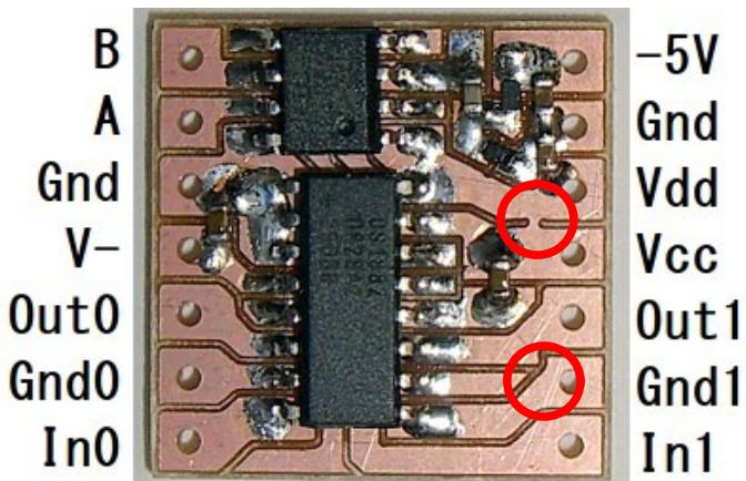
さらにアナログ電源を分離したい場合は、赤丸の部分の「Vcc」と「Vdd」の間の細い銅箔を切断し、Vdd にデジタル電源、Vcc にアナログ電源を供給します。
